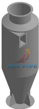
Очистка воздуха производственных помещений возможна только при наличии специальных пылеуловителей. Проблема любого пылеуловителя, заключается в том, что для разного рода пыли и мелких частиц, необходимы разные по конструкции аппараты очистки. Так пылеуловитель Циклон СК-ЦН улавливает липкую пыль и частицы размером более 10 мкм. В то время как Циклон ЛИОТ отвечает за удаление только сухой пыли.
