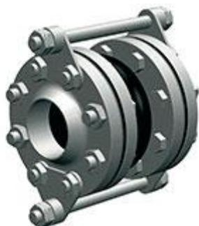
Для повышения прочности конструкции компенсатора на фланцы можно установить дополнительный каркас, как показано на рисунке слева, который в критические периоды работы компенсатора снижает механическую нагрузку на эластичный сильфон.
