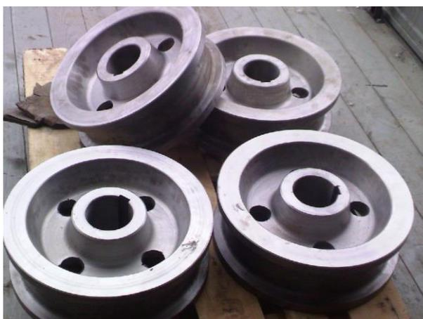
Крановые колеса является одной из наиболее ответственных деталей крана, которые зачастую быстро изнашиваются, при интенсивной эксплуатации.
