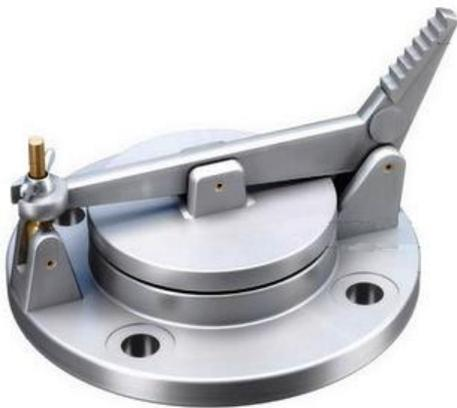
Люки замерные ЛЗ (ЛЗ-80, ЛЗ-150) необходимы для обеспечения доступа во внутреннюю полость резервуара для проведения замеров уровня нефтепродуктов в резервуарах и забора проб нефтепродуктов в емкостном оборудовании на автозаправочных станциях или нефтебазах.
