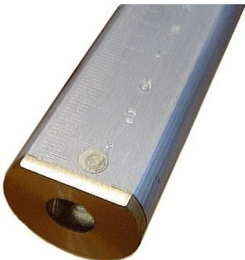
Метрошток МШС относится к метрологическому оборудованию. Метроштки МШС-3,5 и др. предназначены для измерений уровня нефтепродуктов в горизонтальных резервуарах. Методика поверки метроштоков проводится в соответствии с ГОСТ 8.247-2004.
