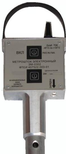
Электронный метрошток пердднозначен для измерения параметров светлых нефтепродуктов в железнодорожных цистернах.
