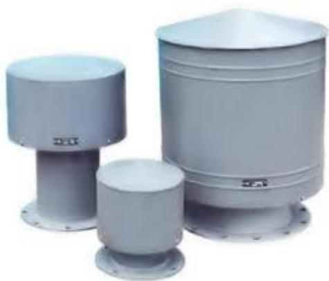
Вентиляционный патрубок предназначен для поддержания постоянного сообщения резервуара с атмосферными газами, это позволяет избежать возникновения вакуума или повышенного давления внутри емкости. Устанавливаются они на хранилища, в которых находятся слабоиспаряющиеся вещества, к таким относятся нефть и ее продукты. По этой причине перед постройкой АЗС требуется заказать вентиляционные патрубки нужного размера.
