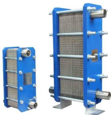
Пластинчатый теплообменник – это теплообменник в котором тепловая энергия одной среды передается другой через стальные пластины, имеющие специальную форму. Пластины имеют гофрированную поверхность изготовленную путем штамповки. Толщина пластин обычно составляет порядка 2мм. Движение рабочих сред происходит в щелях образованных гофрированной поверхностью.
