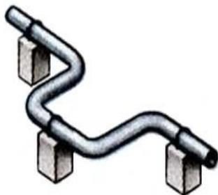
П-образные компенсаторы изготавливают из стандартных труб такого же диаметра, что и трубопровод. Отрезки труб соединяются путем сварки с 90°-градусными стальными отводами. В связи со своими большими габаритами данные компенсаторы зачастую изготавливаются непосредственно на месте монтажа.
