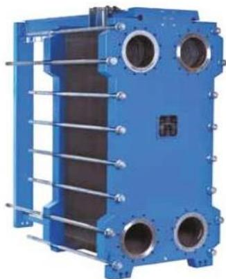
Данный вид теплообменников имеет компактную форму по сравнению с кожухотрубчатыми теплообменниками. Конструкция устроена таким образом, что между двумя массивными металлическими плитами фиксированными направляющими, находятся пластины из нержавеющей стали. Данную конструкцию часто называют пакет. Этот пакет стягивается при помощи винтов до герметичного состояния.
