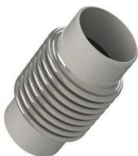
Сильфонные компенсаторы служат для обеспечения защиты трубопровода от нагрузок, возникающих при деформации трубопровода вследствие их теплового расширения или сужения, также защищают трубопровод от вибрации и гидроударов.
