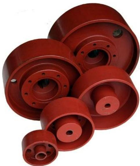
**Тормозные шкивы (барабаны)** применяются совместно с тормозами колодочными и, как правило, устанавливаются между валом электродвигателя и входным валом редуктора либо на обратной стороне входного вала редуктора.
