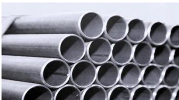
Труба горячедеформированная стальная производится на пильгерстанах из слябового слитка электродуговой сталеплавильной печи МНЛЗ по ГОСТ 8732-78.
