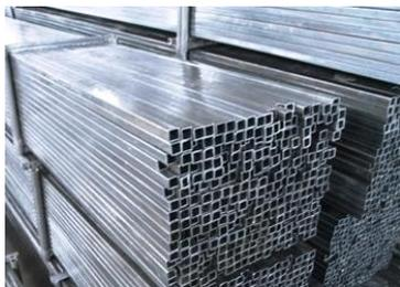
Труба профильная по ГОСТ 30245-03, 13663-86, прокатывается на трубопрокатном стане из стального горячекатанного или холоднодеформированного листа в зависимости от толщины стенки и применяется преимущественно при возведении металлоконструкций.
